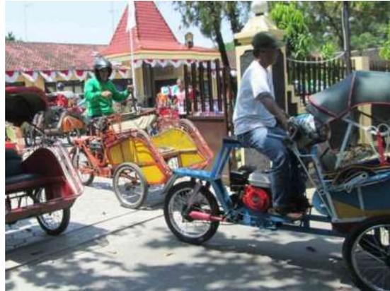
**Gambar 2.3 TTG Alat Transportasi BENTOR (Becak Montor) Berpenggerak Mesin Penggiling**
